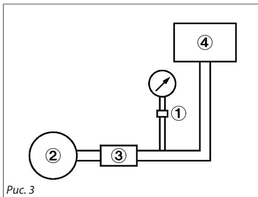
В случаях, когда клапаны закрываются достаточно быстро, может произойти резкое повышение давления по сравнению со значением на которое рассчитан преобразователь. Во избежание повреждения преобразователя давления необходимо установить демпфер.
