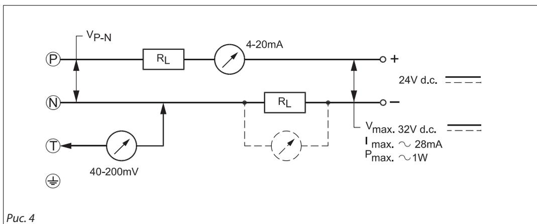
Электрическая схема преобразователя показана на рис. 4. Клеммы P (положительная) и N (отрицательная) используются для подключения напряжения питания.
