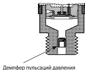
Преобразователь EMP 2, работающий в диапазоне давлений 0 – 6 бар и 0 – 10 бар при длительном испытательном давлении, оснащен встроенным демпфером пульсаций давления для защиты чувствительного элемента от кавитаций и пузырьков воздуха в рабочей среде вследствие резких скачков и пульсаций давления. Такие условия могут быть вызваны насосами или быстро срабатывающими клапанами в системах как высокого, так и низкого давления.
